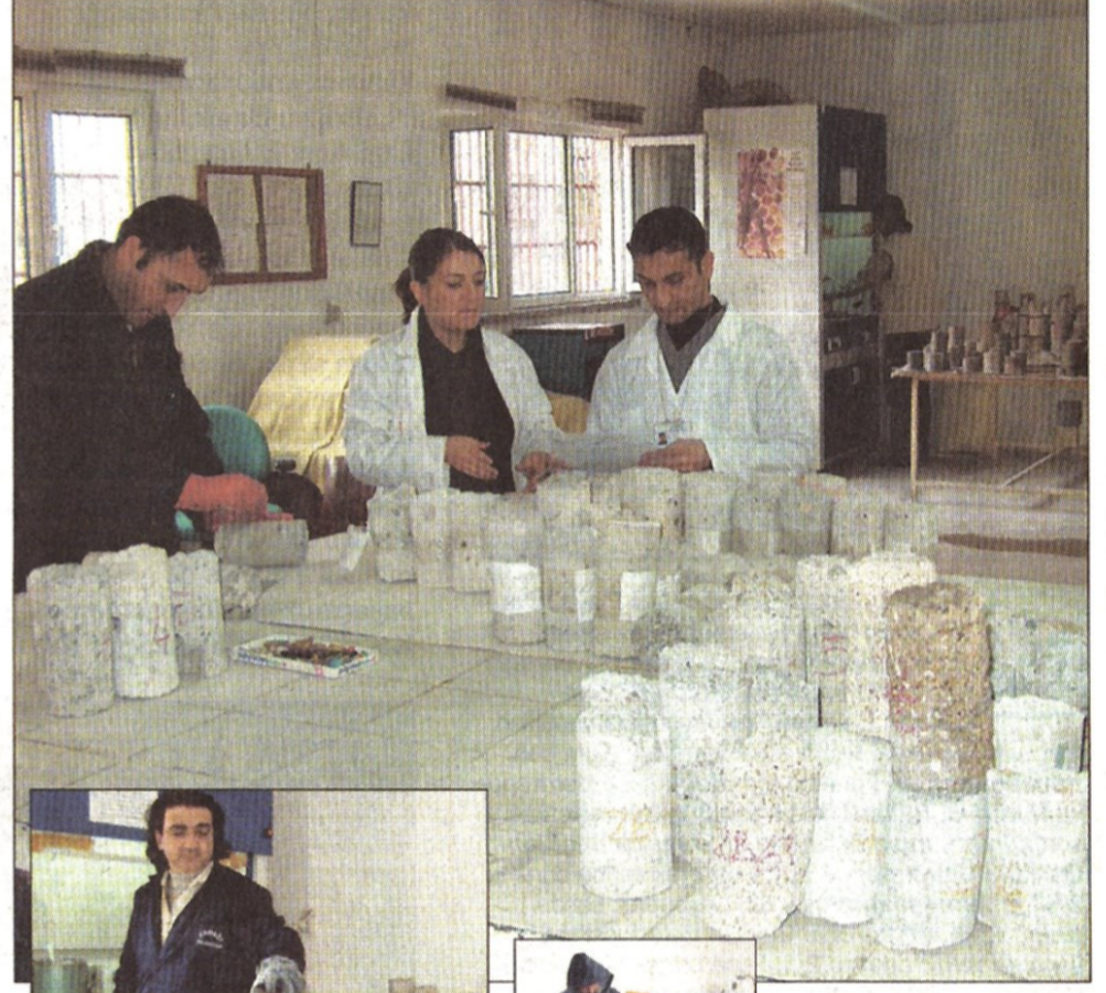
Kadıköy Belediyesi Beton ve Zemin Laboratuvarı'nda binalardan alınan beton örnekleri test ediliyor.
